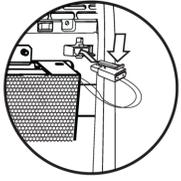
3. Appuyer fermement sur le connecteur jusqu'à ce que les deux languettes se verrouillent en place.
