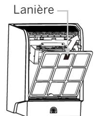
5. Soulever le filtre et le dégager de l'appareil pour le retirer
