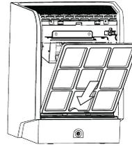
4. Réinstaller le filtre, en insérant d'abord la partie inférieure dans l'appareil.
