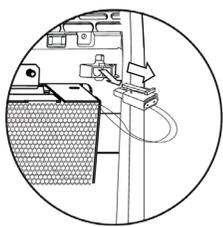
2. Tirer sur le connecteur pour le débrancher.
