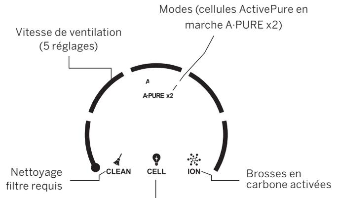
**Clignotement:** Remplacer les assemblages de cellule ActivePure®
