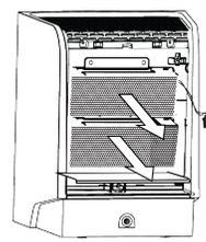
4. Faire coulisser les assemblages de cellule ActivePure vers le bas et la sortir de l'appareil.
