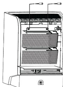
2. Insérer les deux vis papillon et les serrer. Insérer le connecteur des assemblages de cellule ActivePure dans la prise située à l'arrière de l'appareil.
