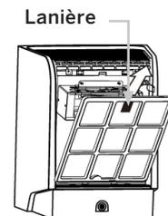
5. Soulever le filtre et le dégager de l'appareil pour le retirer
