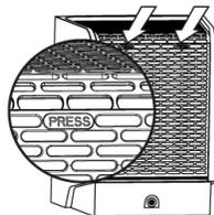
2. Appuyer sur le haut du couvercle arrière pour déverrouiller le panneau arrière
