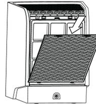
6. Réinstaller le couvercle arrière en insérant d'abord la partie inférieure, puis le verrouiller en place.
