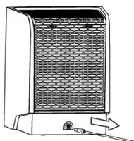
1. Débrancher l'appareil
