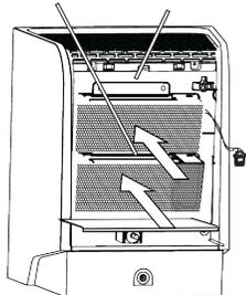
1. Faire coulisser les assemblages de cellule ActivePure vers le haut pour les introduire dans l'appareil. Positionner la rainure en V inférieure sur la languette centrale et tourner vers le haut de manière à ce que le support supérieur se place sur les deux vis situées au-dessus.
