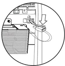
1. Déverrouiller le connecteur des assemblages de cellule ActivePure en appuyant sur les languettes de verrouillage du connecteur.
